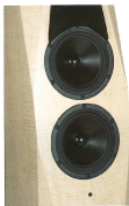
ウーファーは同社において実績のあるノーマックス・ケヴラーを用いた18センチユニットが2基使用される。パツフル製は2層構造となっており、不要な振動を抑えるだけでなく、共振を利用し余分な音を排除する構造とのこと。
