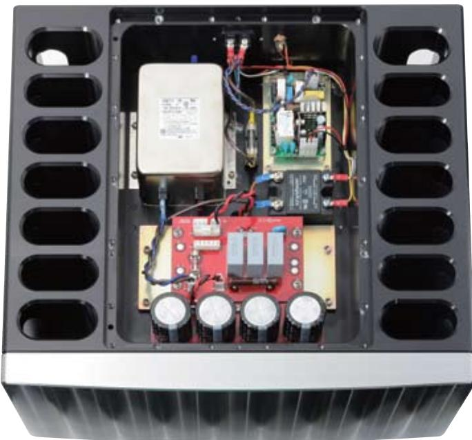
止——不論是主機還是電源供應，都是採用 T-6061 航天級實芯鋁塊以 CNC 車牀準確車製，面板厚達 35mm，頂板和底板，與及主機的背板均為 10mm 厚，與散熱孔洞連成一體的機身更是用一件過的巨形鋁磚上下鏤空而成，手工極度精細，打磨非常滑溜，所有夾口和螺絲位準確無倫，這樣的機器摸上手
